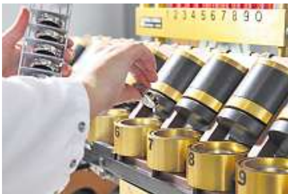
Nach der Montage werden die Uhren mittels Druckluft auf ihre Wasserdichtheit geprüft.
