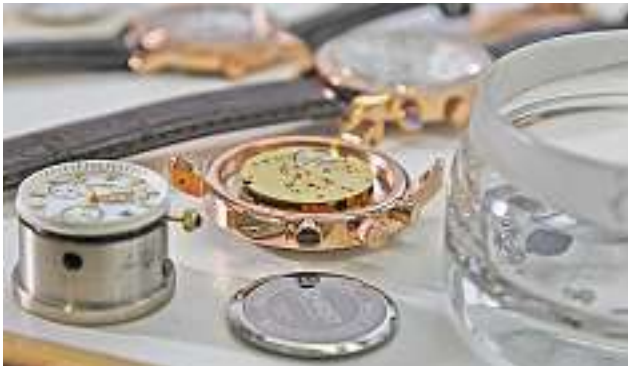
Das Uhrwerk mitsamt Zifferblatt wird zur weiteren Fertigung auf einem Setzring fixiert.
