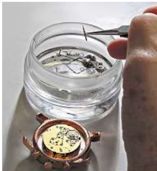
Bei Bedarf werden die Einzelteile vor der Montage in Reinigungsbenzin gesäubert.
