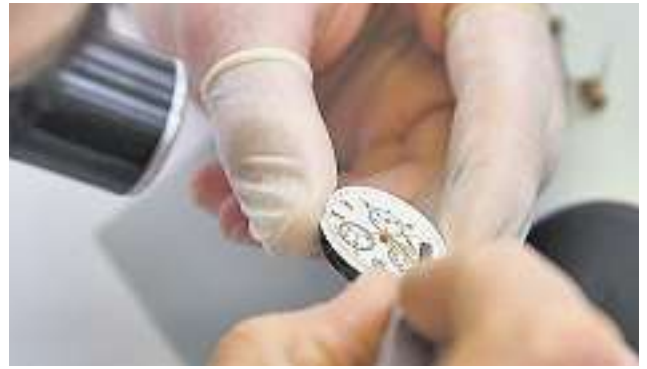
Und jetzt bloss nicht zittern: Nach der Montage des Zifferblattes müssen die Zeiger justiert werden.
